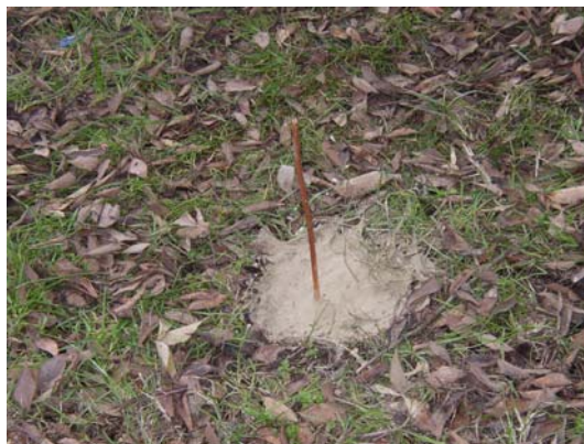
Fig. 3: ultimazione della messa in posto della sonda
