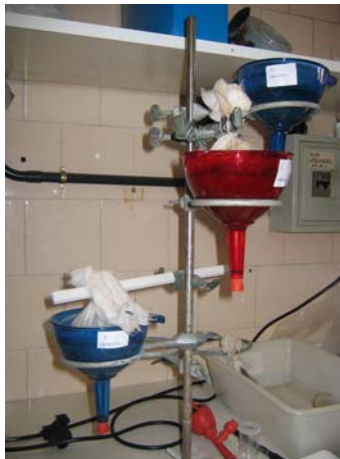
Fig. 3: estrattore di Bearman
