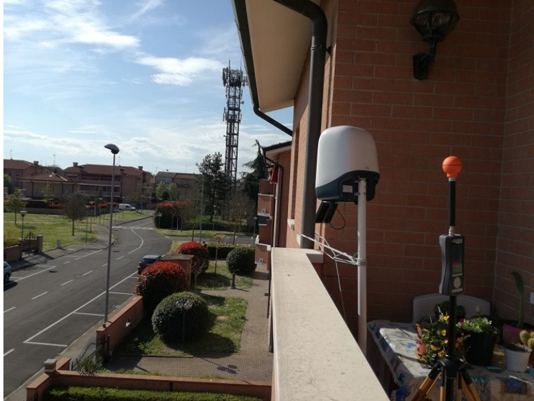
P1- misura manuale e monitoraggio in continuo (distanza impianti circa 110 m)
