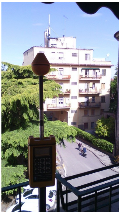
P1 – P3: Misure manuali con EMR300, balcone esterno, 4° piano
