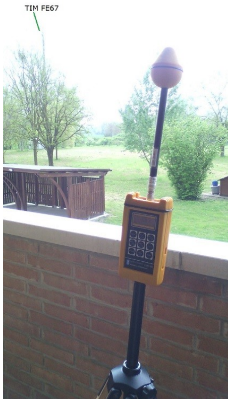
P1 – P3: Misure manuali con EMR300, balcone esterno, 1° piano
