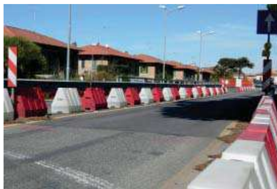
Esempio di recinzione con New Jersey
